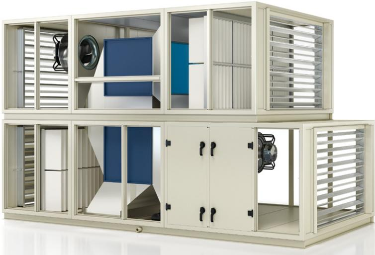
Le composant mécanique le plus volumineux du CyberHandler 2 est son échangeur air/air. L'air chaud provenant du data center est refroidi par l'air extérieur dans l'échangeur sans mélange des deux flux d'air. À cela s'ajoute un refroidissement adiabatique, réalisé également au niveau de l'échangeur par l'intermédiaire de buses de vaporisation d'eau.
