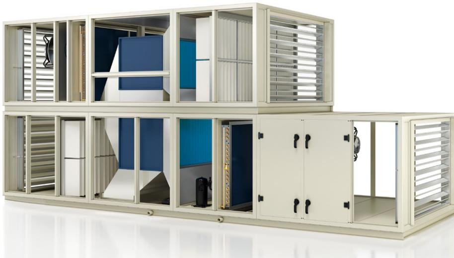
Le refroidissement DX est ajouté au système en place dans les climats très chauds. Le module DX complet, avec compresseur, évaporateur et condenseur, est intégré dans la centrale de traitement d'air. Cette option permet d'obtenir 30 % du refroidissement nécessaire par voie mécanique. Cette configuration permet d'utiliser le CyberHandler 2 dans pratiquement toutes les zones climatiques.
