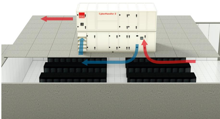
La gaine d'air circule le long du plafond des pièces en direction du CyberHandler 2. Aucun conduit d'air extérieur additionnel n'est requis pour le raccordement.
